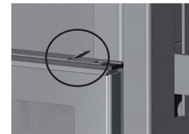
Die Feuerraumtür kann zur Reinigung seitlich aufgeklappt werden. Öffnen Sie hierfür die Stahl-Fronttür und lösen Sie die Federn am oberen und unteren Rahmen der Feuerraumtür. Diese lässt sich jetzt ganz leicht aufschwenken. Achten Sie beim Verschliessen dass beide Federn (oben und unten) richtig einrasten.
